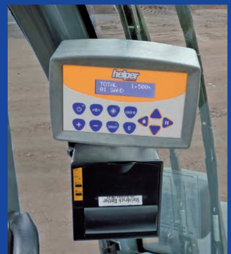
In Fahrerkabine montiertes Onboard-Wägesystem HELPER MINI mit optionalem Thermodrucker
